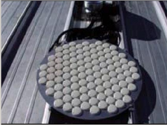
実験車両に搭載した 109素子 アレイアンテナ
