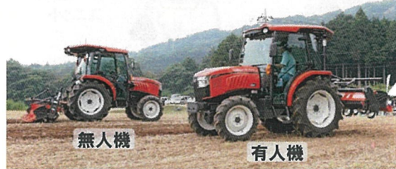
無人機と有人機の2台を使用した協調作業 (ロータリ耕うん)
