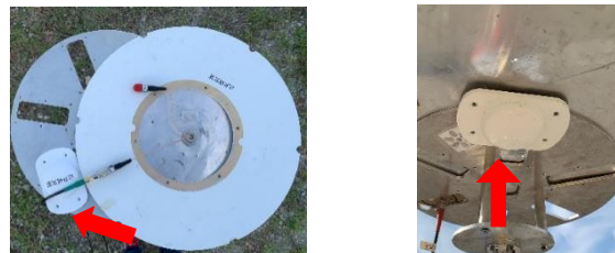
図2 両円偏波アンテナ (天頂方向 (左) と天底方向 (右))
