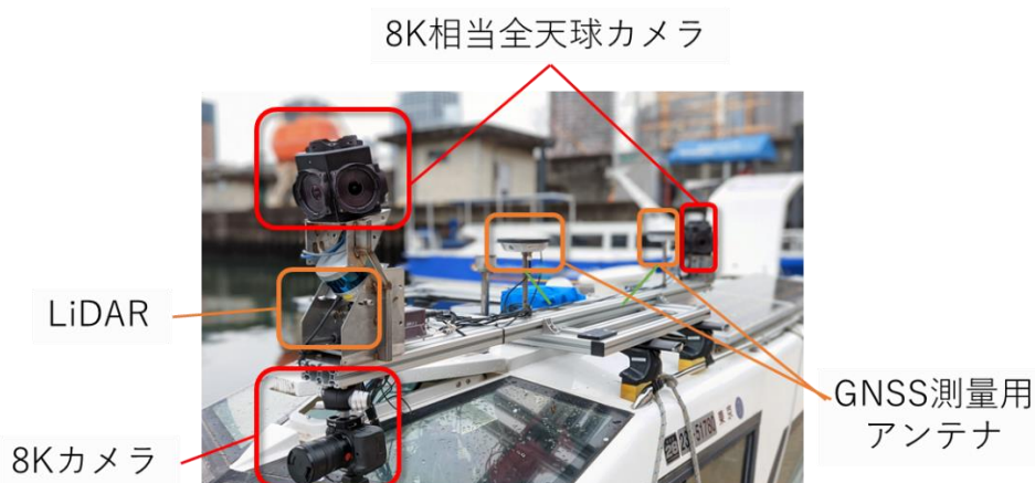
図 4 計測システムの構成
