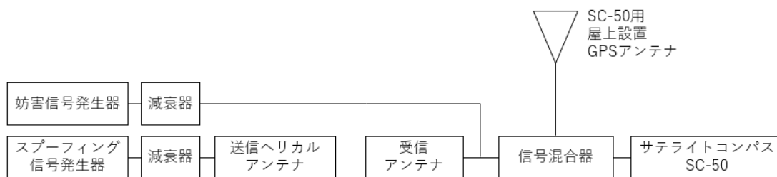
図1 SC-50 に対する妨害及びスプーフィング実験接続図
