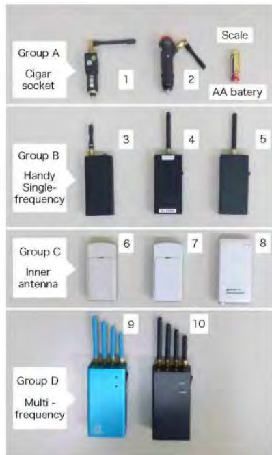
図1 試験されたPPDとグループ分け Fig. 1 PPDs tested and grouping.
